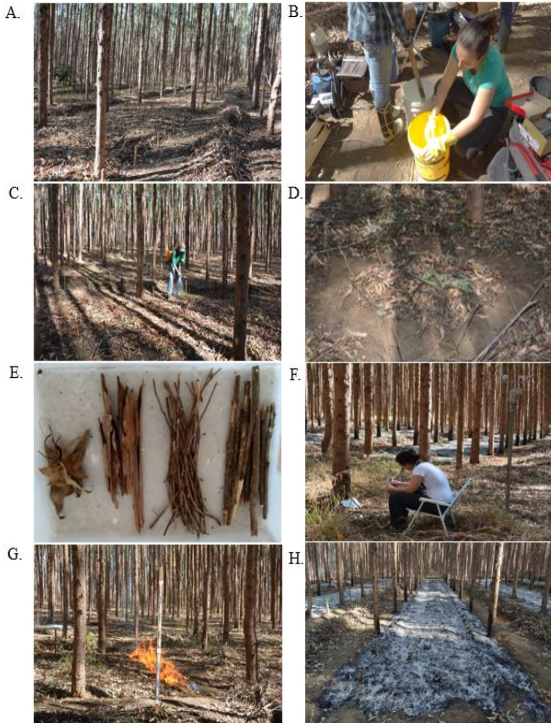
Figura 2. Instalação das parcelas (A), preparação dos retardantes nas parcelas (B), aplicação dos retardantes nas subparcelas (C), amostragem de serrapilheira (D), separação de classes (E), controle de variáveis micrometeorológicas (F), avaliação do comportamento do fogo (G) e avaliação do material combustível remanescente (H), em área de E. urograndis (Clone H13) em Sorriso-MT, Brasil
