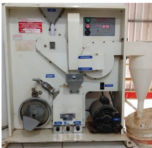
Figura 4. Provador de arroz com descasque, brunição e classificação da fração de grãos quebrados no classificador de renda (Fonte: o autor). Sinop-MT, 2018.
