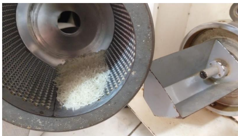
Figura 5. Detalhes visuais do trieur alveolado para separação de grãos inteiros de arroz, componente do provador de arroz (Fonte: o autor). Sinop-MT, 2018.
