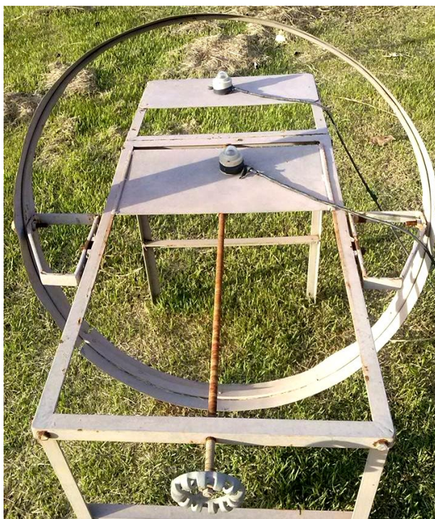
Figura 5. Anel de sombreamento MEO (MELO, 1994) instalado na Estação Meteorológica Automática da UFMT, Campus Universitário de Sinop.
