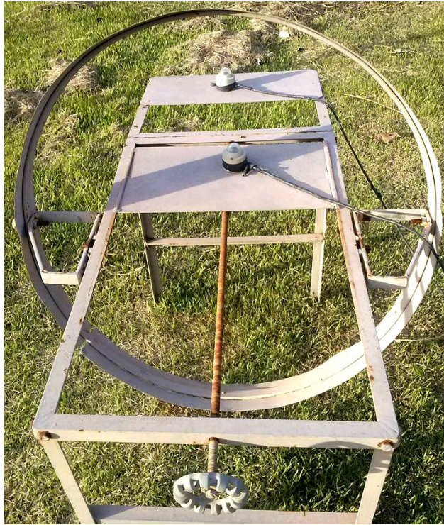
Figura 1. Anel de sombreamento MEO instalado na Estação Meteorológica Automática do Campus Universitário da UFMT/Sinop
